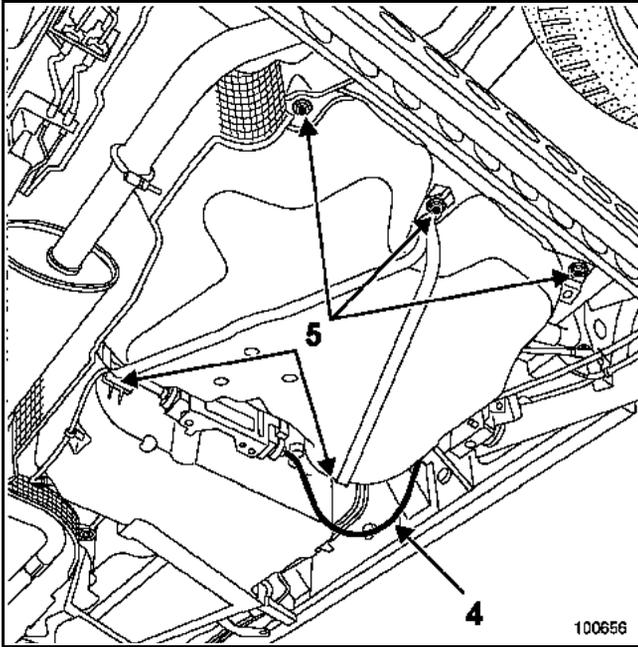
Dégager le câble de frein de parking automatique (4) pour permettre la descente du réservoir.
