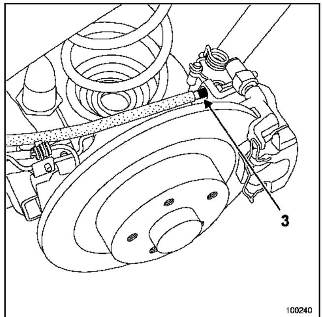
Décrocher l'arrêt de câble du frein de parking automatique (3) côté droit.
