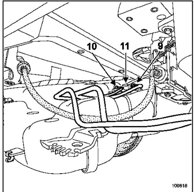
Descendre légèrement le réservoir puis débrancher :
